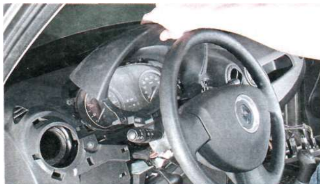
5. Аналогично, преодолевая сопротивление фиксаторов, снимаем козырек щитка приборов.
