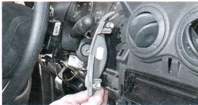
5. Аналогично, преодолевая сопротивление фиксаторов, снимаем козырек щитка приборов.
