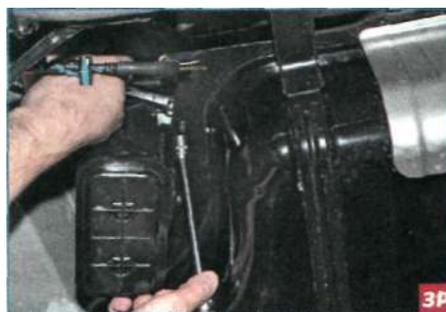
Аналогично отворачиваем гайку болта переднего крепления кронштейна адсорбера.
