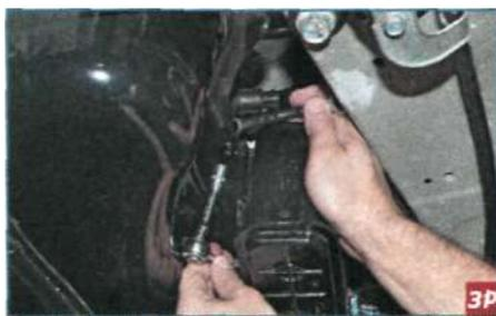
Головкой «на 10» с удлинителем отворачиваем гайку болта заднего крепления кронштейна адсорбера к отбортовке топливного бака, удерживая болт от проворачивания ключом того же размера.
