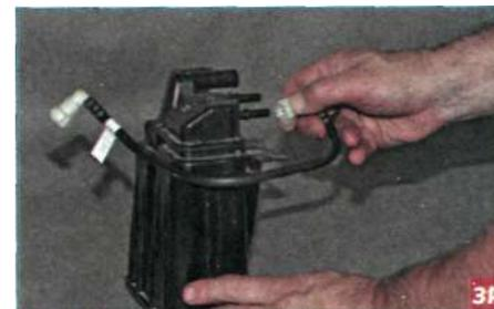
Нажав на фиксатор наконечника трубки отвода паров топлива из адсорбера, снимаем наконечник с переднего штуцера адсорбера.
