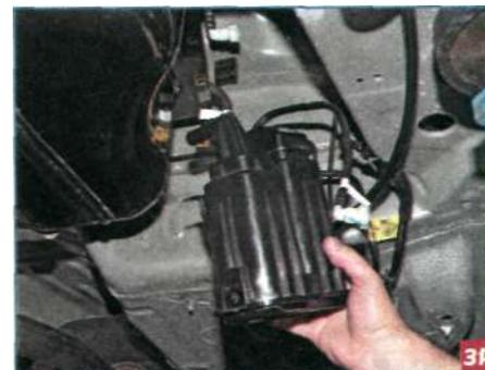
...и снимаем адсорбер в сборе с кронштейном и трубкой отвода паров топлива.
