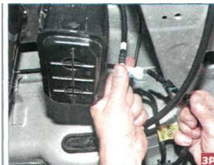
...снимаем наконечник с трубки, которая проходит под днищем автомобиля и соединяется с клапаном продувки адсорбера.
