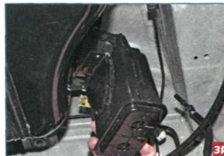
Отводим от бака адсорбер и опускаем его.
