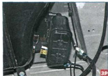
Адсорбер прикреплен к топливному баку справа.
