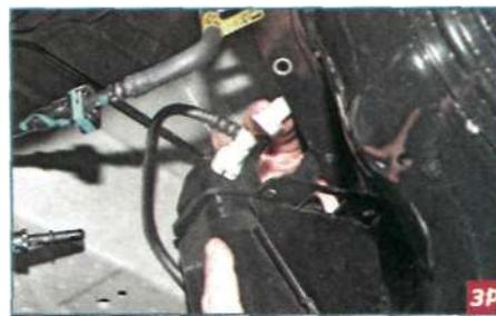
Нажав на фиксатор наконечника трубки подвода паров топлива к адсорберу, снимаем наконечник со среднего штуцера адсорбера.
