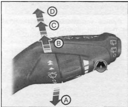
А. Однократное включение. В. Прерывистый или автоматический режим работы. С. Нормальный режим работы стеклоочистителей. О. Работа с высокой частотой.
