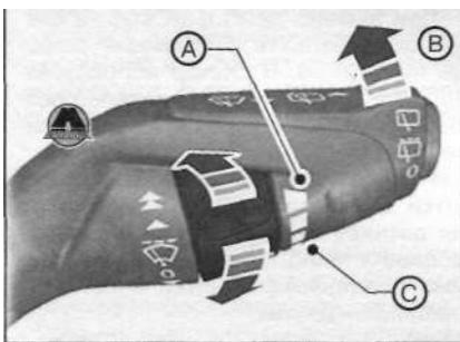
А. Прерывистая работа стеклоочистителей. В. Длинные интервалы между взмахами щеток. С. Для регулировки интервалов между взмахами щеток можно использовать поворотный переключатель.
