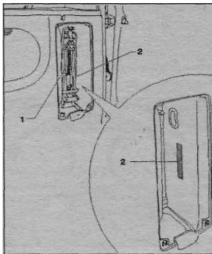
(VIN) открыть крышку боковой обивки справа и снять домкрат - 1 -.
