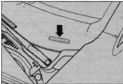
Идентификационный номер автомобиля (VIN) - стрелка - находится на левой стороне автомобиля за ветровым стеклом в области крепления стеклоочистителя. Идентификационный номер автомобиля (VIN) снаружи автомобиля можно прочесть в смотровом окошке на ветровом стекле. Прозрачное поле находится с левой стороны в нижней части ветрового стекла.
