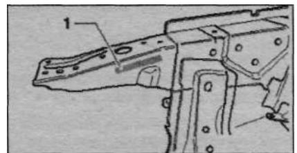
гическим причинам был выбит на лонжероне колесной арки вверх справа внутри - 1 -.
