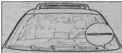
**Идентификационный номер автомобиля (VIN) внутри на крышке крепления заднего фонаря справа**
