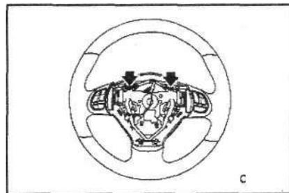
9. Отверните винты с обратной стороны рулевого колеса и снимите переключатель команд системы круиз-контроля.
