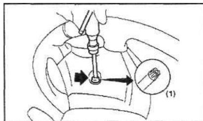
Отключите жгут проводов звукового сигнала.
