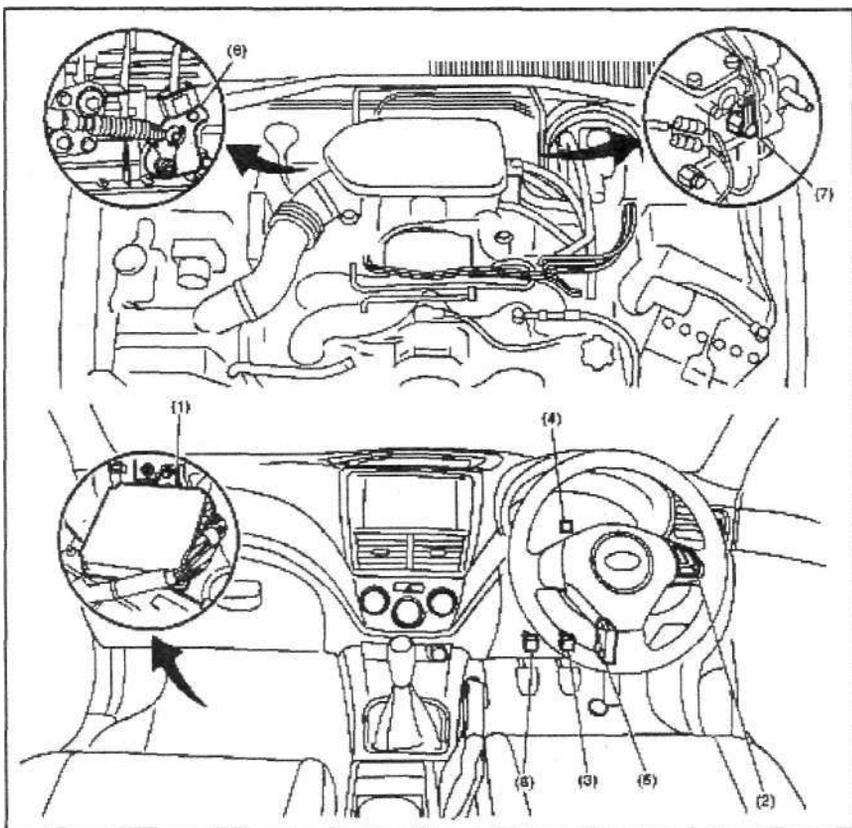
1. Блок управления двигателем (ECM)
