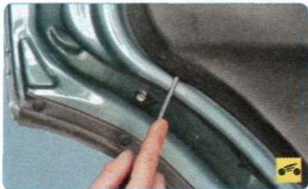
8. Подденьте обивку отверткой и, преодолевая сопротивление фиксаторов крепления обивки задней двери...
