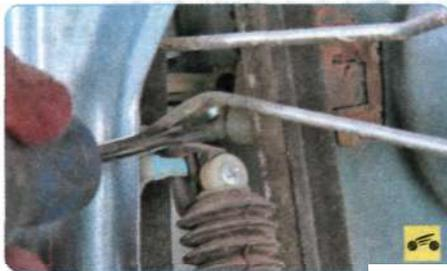
3. Подденьте отверткой и отсоедините тяги привода от замка,
