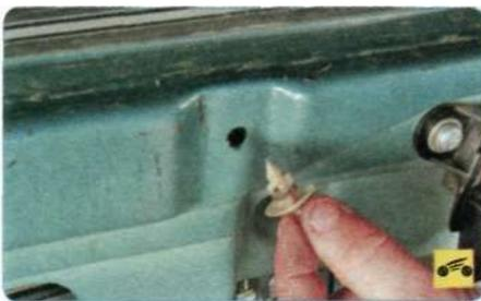
10. Снимите фиксаторы крепления обивки, если они остались в двери. Сломанные фиксаторы замените.
