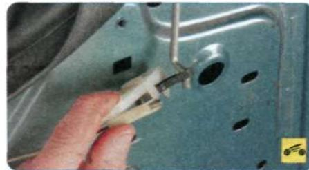
8. ...и снимите кронштейн привода блокировки замка,
