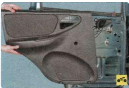
9. ...снимите ее, пропустив через отверстие в обивке кнопку блокировки замка двери.
