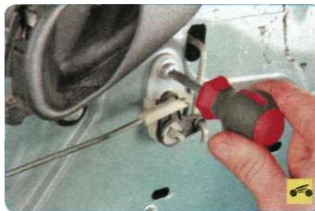
7. Выверните винт крепления кронштейна привода блокировки замка двери...
