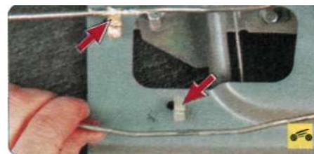
10. Извлеките тяги привода замка двери и привода блокировки двери из держателей.
