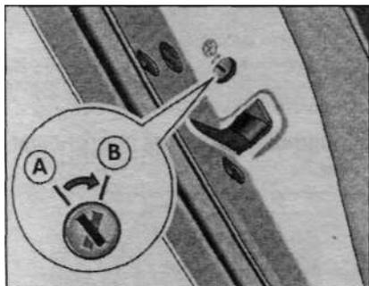
В задней левой двери: блокировка от случайного открывания изнутри (A) выключена, (B) включена.
