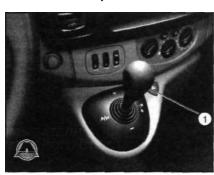
При нажатии на кнопку (1) включаются одновременно все габаритные огни и указатели поворотов, независимо от положения ключа в замке зажигания. Используйте аварийную све-
