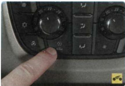
5. Клавишей выключателя 12 режима рециркуляции выбирают режимы подачи воздуха снаружи или рециркуляции. При нажатии на клавишу выключателя один раз включается режим рециркуляции, наружный воздух в салон не поступает, а вентилятор воздушонагревателя обеспечивает циркуляцию воздуха внутри салона. При этом в клавише выключателя загорается нижняя контрольная лампа.
