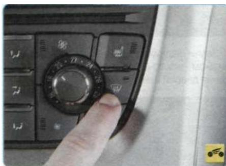
6. Для быстрого удаления влаги или инея с ветрового стекла и стекол передних дверей при повышенной влажности воздуха нажмите на клавишу выключателя 9 интенсивной подачи воздуха на ветровое стекло и стекла передних дверей.
