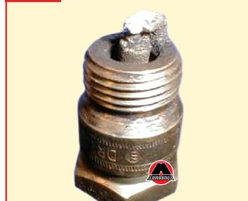
Свеча зажигания, изображенная на фото №8, имеет электрод, покрытый золотыми отложениями. При этом цвет отложений не играет решающей роли. Причина такого нароста – сгорание масла вследствие износа или залипания маслосъемных поршневых колец. На двигателе наблюдается повышенный расход масла, из выхлопной трубы валит синий дым. Процедура замены поршневых колец описывается в главе «Механическая часть двигателя». Изд-во "Monolith"
