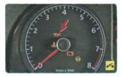
В комбинации приборов вашего автомобиля установлена сигнальная лампа аварийного падения давления масла в двигателе. Для надежной работы двигателя необходимо, чтобы в системе смазки двигателя постоянно обеспечивалось достаточно высокое давление.
