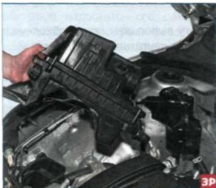
Снимаем воздушный фильтр (см. «Снятие воздушного фильтра», с. 77).
