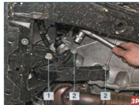
Снизу автомобиля головкой «на 18» отворачиваем болт 1 крепления передней опоры силового агрегата к подрамнику передней подвески и два болта 2 крепления опоры к картеру коробки передач.
