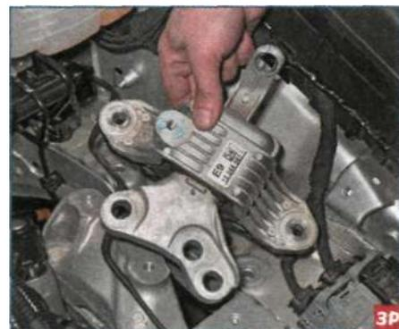
Вынимаем левую опору силового агрегата из моторного отсека.
