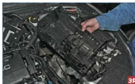
Снимаем площадку аккумуляторной батареи (см. «Снятие площадки аккумуляторной батареи», с. 220).
