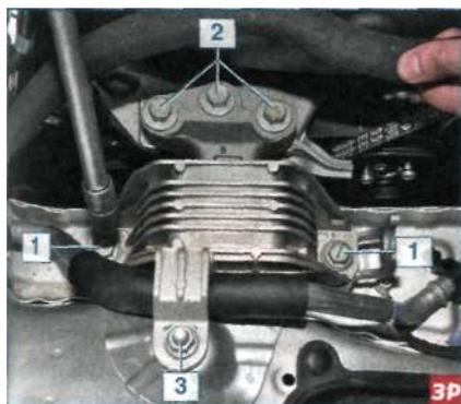
Головкой «на 15» отворачиваем два болта 1 крепления правой опоры силового агрегата к лонжерону, три болта 2 крепления опоры к кронштейну двигателя и гайку 3 крепления опоры к брызговику кузова.
