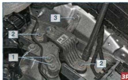
Головкой «на 15» отворачиваем три болта 1 крепления левой опоры сило-
