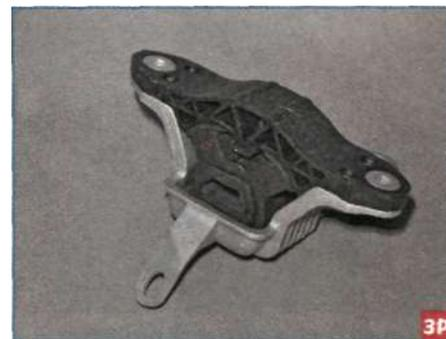
Левая опора силового агрегата.
