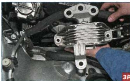
Вынимаем опору из моторного отсека.
