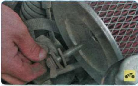
4. ...и извлеките болт из корпуса воздушного фильтра.
