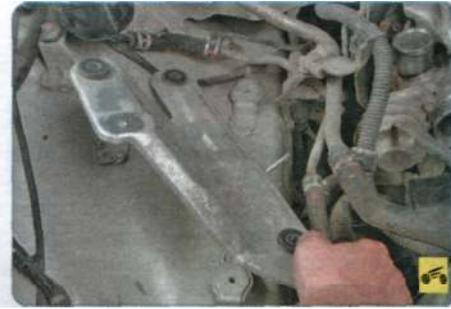
7. ...и снимите кронштейн крепления корпуса воздушного фильтра к кузову автомобиля.
