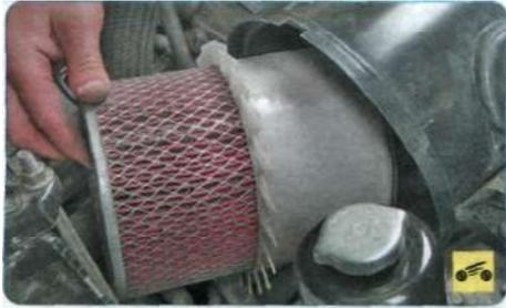
5. Извлеките из корпуса фильтрующий элемент.
