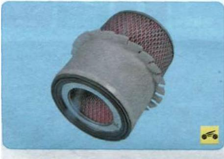
6. Осмотрите фильтрующий элемент, продуйте его сжатым воздухом, сильно загрязненный фильтрующий элемент замените.
