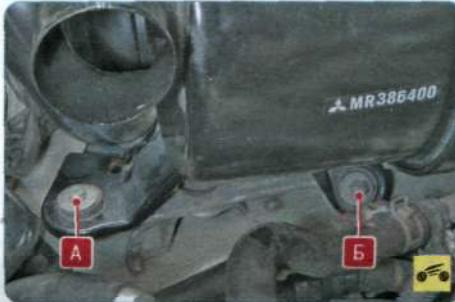
4. ...выверните болт А и отверните гайку Б крепления...
