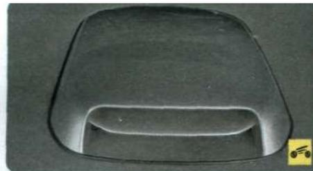
Воздух для охлаждения поступает снаружи через воздухозаборник на капоте автомобиля.
