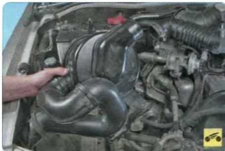
5. ...и снимите корпус воздушного фильтра.
