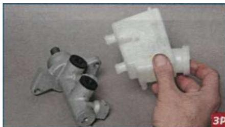
Снимаем бачок, преодолевая сопротивление резиновых соединительных втулок.
