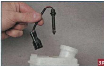
...и, сдвинув ее, снимаем колодку проводов датчика с бачка.
