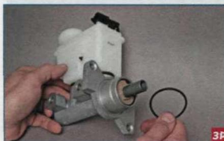
Если кольцо повреждено или потеряло эластичность, вынимаем его из проточки корпуса цилиндра и заменяем.
