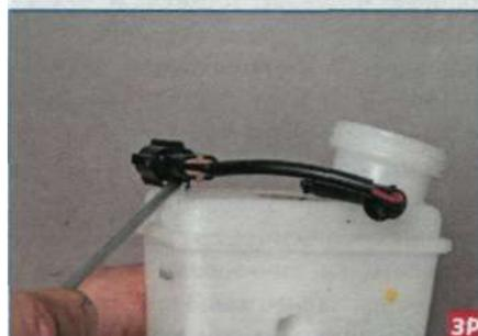
Отверткой освобождаем фиксатор колодки...
