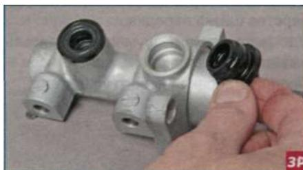
Сжимаем пальцами верхний край втулки и вынимаем ее из отверстия главного тормозного цилиндра.
