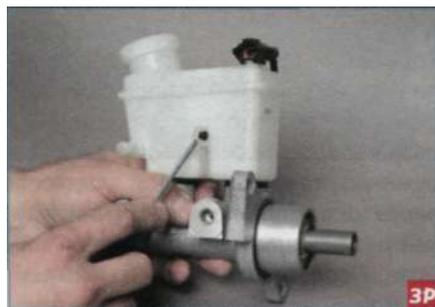
Отверткой вытаскиваем датчик уровня тормозной жидкости...
