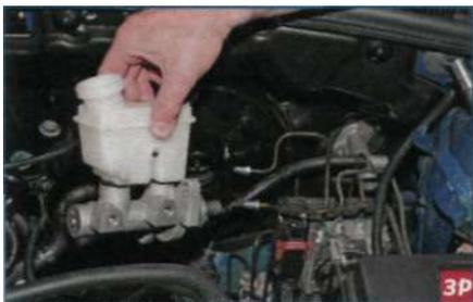
...и снимаем главный тормозной цилиндр в сборе с бачком гидроприводов. Заменить датчик уровня тормозной жидкости и бачок гидроприводов можно на автомобиле, не демонтируя главный тормозной цилиндр. Для наглядности показываем эти операции на снятом главном тормозном цилиндре.
