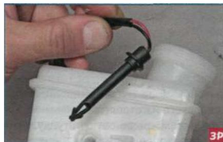
...и вынимаем датчик из отверстия бачка.
