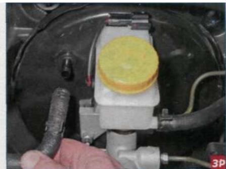
Снимаем шланг со штуцера усилителя. Отсоединяем от штуцера главного тормозного цилиндра шланг подвода жид-
