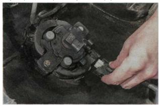
4. Поворачиваем лампу против часовой стрелки и извлекаем из фары.
