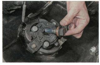
5. Устанавливаем новую лампу и детали в обратной последовательности.
