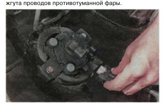
4. Ключом **на** 10 мм отворачиваем два болта крепления и снимаем фонарь.
