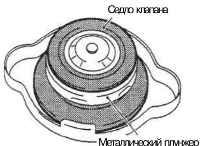
Проверьте, не вздулось ли седло клапана до такой степени, что не видно кромки плунжера, если смотреть на него вертикально сверху. Убедитесь, что на седле клапана нет грязи и повреждений. Потяните за вакуумный клапан, откройте его и убедитесь, что он полностью закрывается при отпускании.
