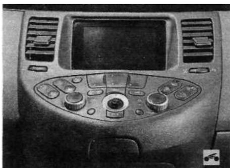
Автомобиль оснащен цветным жидкокристаллическим дисплеем (5,8" по диагонали), установленным на центральной консоли панели приборов. С помощью дисплея можно контролировать выполнение ряда функций, которыми управляют с блока кнопок и рукояток центральной консоли (табл. 1.2).
