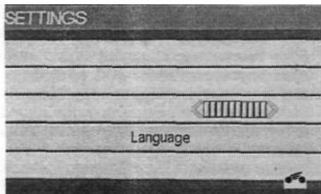
Для выбора языка информационных сообщений нажмите на кнопку 6 (см. рис. 1.11) и с помощью джойстика 17 выберите на дисплее виртуальную кнопку «Language» (язык). Нажмите на кнопку «ENTER» (ввод) джойстика. На дисплее появится перечень возможных языков. После установки определенного языка вся информация будет выводиться на дисплей на этом языке (до последующего изменения его установки).
