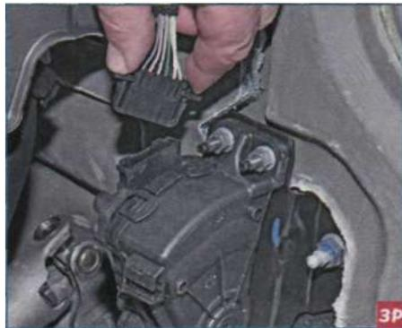
Сжав фиксаторы колодки жгута проводов панели приборов, вынимаем колодку из разъема модуля.
