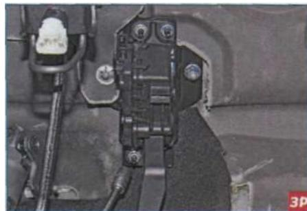
Головкой «на 10» отворачиваем три гайки крепления модуля педали «газа» к щитку передка...
