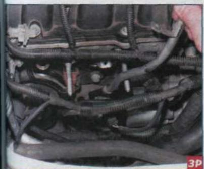
и вынимаем направляющую трубку из отверстия в блоке цилиндров.
