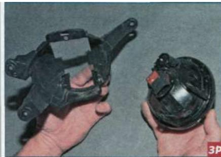
Снимаем фару с кронштейна. Устанавливаем противотуманную фару в обратной последовательности.
