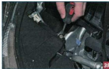
Поворачивая крестообразной отверткой регулятор, расположенный ближе к оси автомобиля, изменяем положение светового пучка в горизонтальной плоскости.
