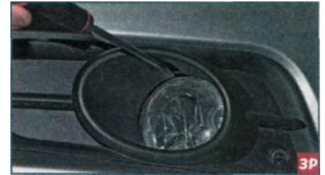
Поворачивая крестообразной отверткой регулировочный винт, изменяем положение светового пучка в вертикальной плоскости.
