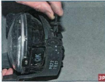
...и вынимаем пистон крепления фары. Аналогично вынимаем другой пистон крепления фары.
