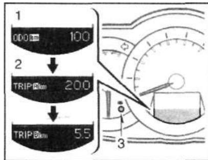
На многофункциональном информационном дисплее отображаются следующие счетчики. Счетчики меняются нажатием на кнопку сброса счетчика пробега.
