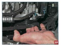
...надеваем ремень на шкив насоса гидроусилителя.
