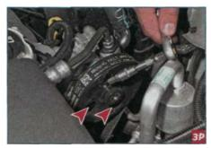
Через отверстия в шкиве насоса шестигранником «на 8» ослабляем затяжку трех винтов крепления насоса.
