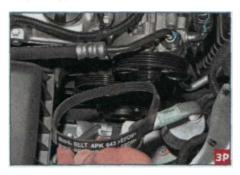
...вынимаем ремень из моторного отсека.
