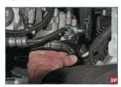
...и сдвигаем ремень со шкива насоса гидроусилителя.
