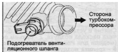
2. (Двигатели 4M41 и 4D56) Установите впускную воздушную трубку так, чтобы ее установочные метки были расположены, как показано на рисунке.
