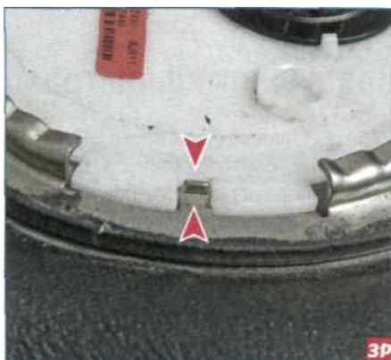
При установке топливного модуля в бак совмещаем вырез в крышке топливного модуля с язычком на фланце отверстия бака.
