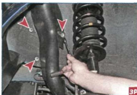
Головкой «на 10» отворачиваем три гайки крепления защитного кожуха наливной трубы...
