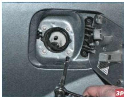
...головкой «на 8» отворачиваем четыре самореза крепления фланца наливной трубы.
