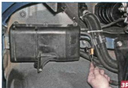
Головкой «на 10» отворачиваем болт крепления кронштейна наливной трубы и вентиляционной трубки.
