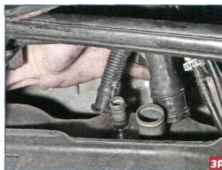
Отсоединяем наливную трубу и вентиляционную трубку от патрубков бака.
