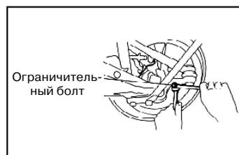
Если не удастся отрегулировать величину угла поворота колеса до номинального значения, заменить изношенные или поврежденные части системы рулевого управления.
