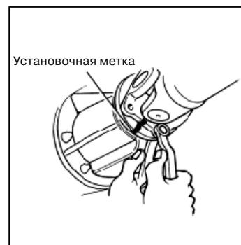
2. Отвернуть четыре соединительных болта и гайки.
