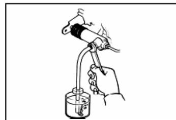
5. Повторять операцию до тех пор, пока в тормозной жидкости не пропадут воздушные пузыри.
