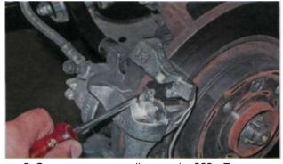
5. Снимаем тормозной шланг (с. 263, «Тормозные шланги — замена»).
