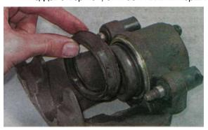
2. Подаем небольшое давление сжатого воздуха к отверстию для подвода тормозной жидкости и выталкиваем поршень, подложив деревянный брусок, чтобы не повредить поршень.
