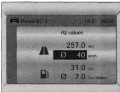
Показания двух бортовых компьютеров могут сбрасываться раздельно, и таким образом предоставляется возможность оценки данных на протяжении различных промежутков времени. Выбрать нужные данные бортового компьютера. Значение выбранной функции сбрасывается и рассчитывается заново.
