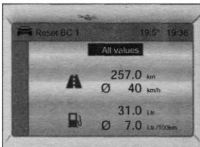
Чтобы сбросить все данные бортового компьютера, выбрать пункт меню All values. После сброса на дисплее бортового компьютера вместо выбранных показаний будет отображаться строка прочерков"—". Через некоторое время отобразится заново определенное значение.
