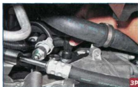
**Нажав на фиксатор колодки провода...**
