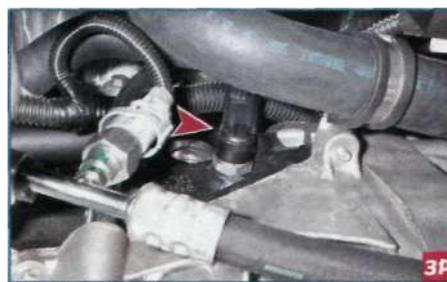
**Датчик ввернут в отверстие, расположенное в нижней части передней стенки блока цилиндров, слева.**
