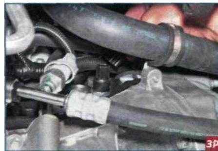
**...отсоединяем колодку провода от разъема датчика.**
