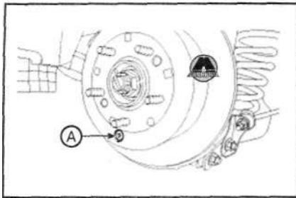
4. Вращайте шестерню регулятора с помощью отвертки, пока диск не прекратит двигаться. Затем поверните шестерню на 4 зубца в противоположном направлении.
