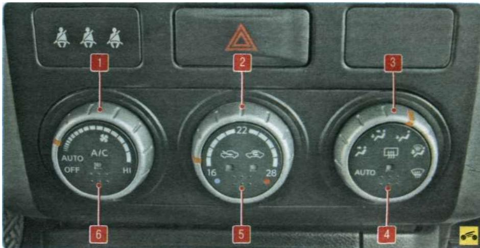
**Рис. 1.10.** Блок управления системой отопления, кондиционирования и вентиляции салона: 1 - рукоятка регулятора скорости вращения вентилятора; 2 - рукоятка регулятора температуры; 3 - рукоятка изменения направления воздушных потоков; 4 - клавиша включения электрообогрева стекла двери задка; 5 - клавиша включения режима рециркуляции; 6 - клавиша выключателя кондиционера
