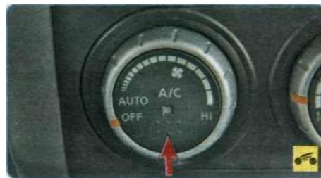
**6 - клавиша выключателя кондиционера.** Для включения кондиционера нажмите на клавишу. При этом в клавише загорается сигнализатор. При повторном нажатии на клавишу кондиционер выключается - сигнализатор в клавише гаснет.
