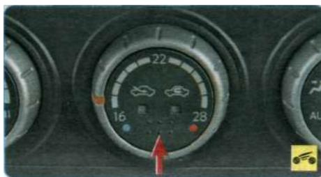
**5 - клавиша включения режима рециркуляции.** При нажатии на клавишу воздух циркулирует в салоне автомобиля по замкнутому циклу. При этом загорается сигнализатор в правой части клавиши. При повторном нажатии на клавишу режим рециркуляции выключается, забор воздуха осуществляется снаружи автомобиля, а в левой части клавиши загорается сигнализатор;
