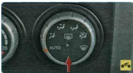
**4 - клавиша включения электрообогрева стекла двери задка.** При нажатии на клавишу при работающем двигателе включается электрообогрев стекла двери задка. Одновременно включается и электрообогрев наружных зеркал заднего вида. При этом в клавише загорается сигнализатор. Электрообогрев работает примерно 15 мин, затем автоматически выключается. При повторном нажатии на клавишу электрообогрев выключается сразу - сигнализатор в клавише гаснет;
