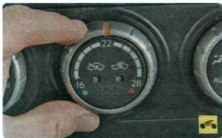
**2 - рукоятка регулятора температуры.** Для повышения температуры воздуха поверните рукоятку по часовой стрелке, для снижения температуры - против часовой стрелки. Вы можете установить температуру от 16 до 28 °C;
