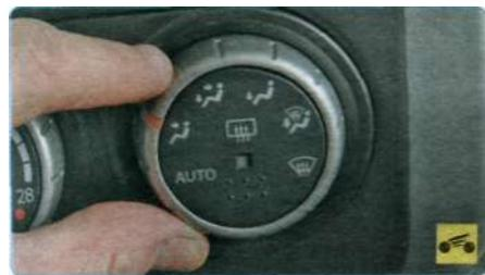
**3 - рукоятка изменения направления воздушных потоков.** Для изменения направления подачи воздуха установите рукоятку в одно из шести фиксированных положений (начиная с левого, по часовой стрелке):
