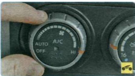
**1 - рукоятка регулятора скорости вращения вентилятора.** Для повышения скорости вращения вентилятора поверните рукоятку по часовой стрелке, для снижения - против часовой стрелки. При установке рукоятки в положение «OFF» вентилятор выключен.
