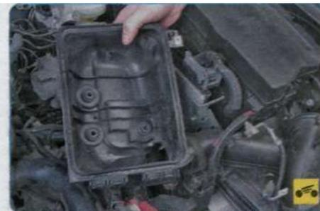
3. Снимите корпус воздушного фильтра (см. «Снятие и установка воздушного фильтра», с. 94).
