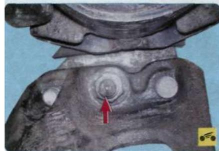
4. Выверните болт крепления снизу.
