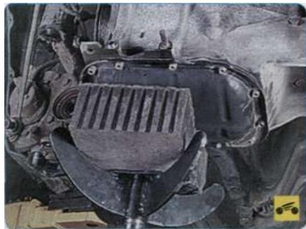
2. Установите опору под картер двигателя через деревянную или резиновую проставку
