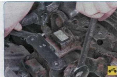
4. Придерживая одним ключом от проворачивания болт крепления левой опоры двигателя к кронштейну коробки передач, вторым ключом отверните гайку болта и извлеките болт
