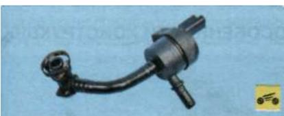
...установлен электромагнитный клапан продувки адсорбера, который по сигналам ЭБУ управления двигателем переключает режимы работы системы.
