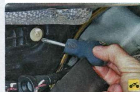
7. Выверните фиксаторы двух поршней крепления адсорбера к топливному баку.
