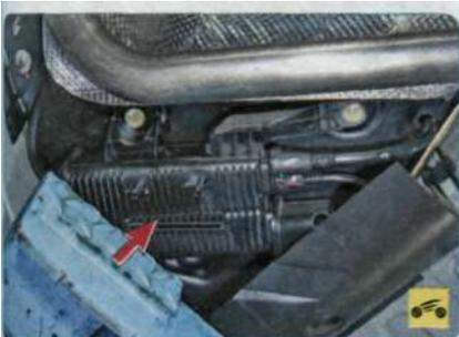
Адсорбер установлен на топливном баке (левой стороны).
