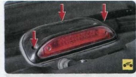
2. Выверните три винта крепления фонаря дополнительного стоп-сигнала.
