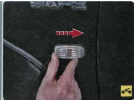
2. Сдвиньте боковой указатель поворота против направления движения автомобиля...
