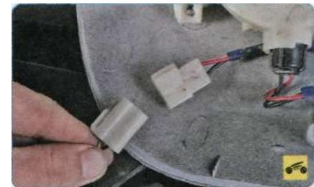
4. Отожмите фиксатор колодки и разъедините колодки жгута проводов.
