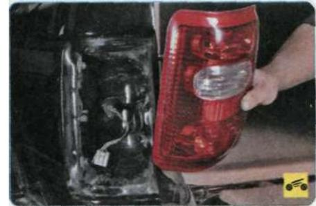
7. Снимите задний фонарь с автомобиля.
