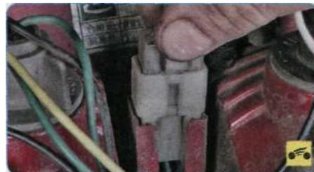
5. Отожмите фиксатор колодки.
