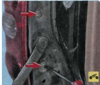
3. Выверните два винта крепления заднего фонаря.
