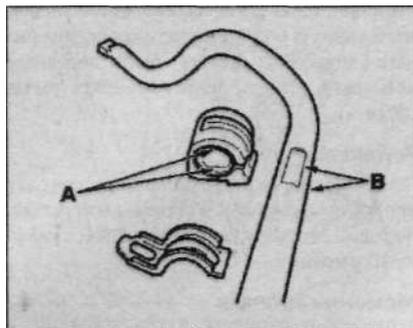
Отодвинуть опоры. Совместить внутренние лыски (А) с лысками (В) на стабилизаторе поперечной устойчивости (по одной с каждой стороны).
