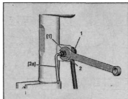
Опасность повреждения шарнира стойки (1). Выполнить следующее: Зафиксировать
