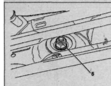
Снять: Гайка (5) верхнего крепления несущего элемента (Чтобы шток амортизатора не вращался, зафиксировать его наконечником TORX 45); Несущий элемент.
