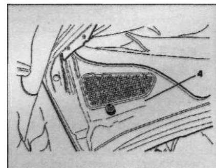
Снять защиту проема ветрового стекла (4).
