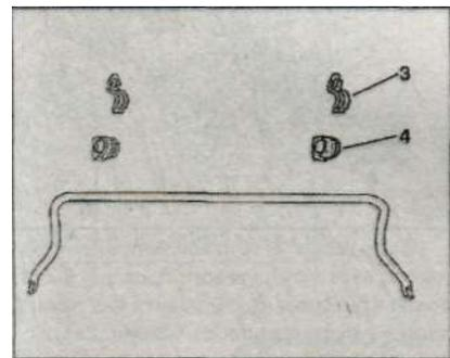
Стабилизатор поперечной устойчивости шарнирно закреплен двумя эластичными крышками (4).
