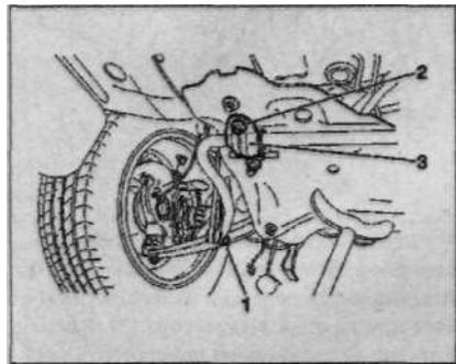
Снять: Гайки тяги на стабилизаторе поперечной устойчивости (1); болтов крепления опоры (2); Скобу (3) резиновой крышки стабилизатора поперечной устойчивости; Резиновая крышка; Стабилизатор поперечной устойчивости.
