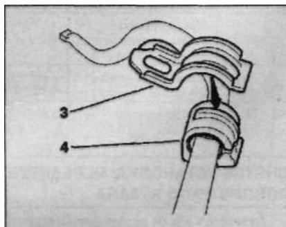
Установить скобу (3) на резиновую крышку (4). Установить штангу стабилизатора так, чтобы элемент, исключая неправильную установку, был расположен справа. Установка в обратном порядке.
