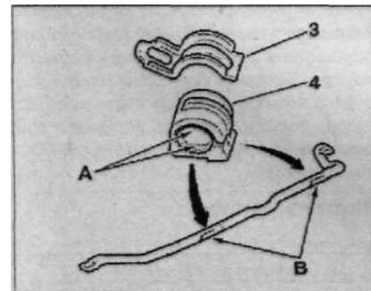
Правильное позиционирование в боковом и горизонтальном направлениях обеспечивается двумя лысками (А) в нижней части опоры (4) и двумя метками (В) на участке квадратного сечения. Скоба (3) удерживает весь узел в сборе.
