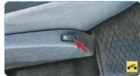
В варианном исполнении на боковых обливках передних сидений установлены выключатели нагревательных элементов подушек передних сидений. Обогрев сидений можно
