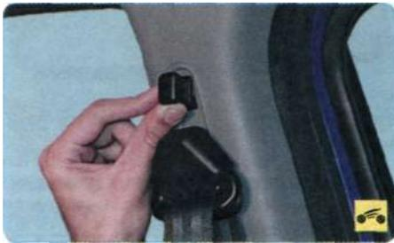
Для перемещения крепления по вертикали нажмите на рычаг фиксатора вверх, чтобы поднять крепление...
