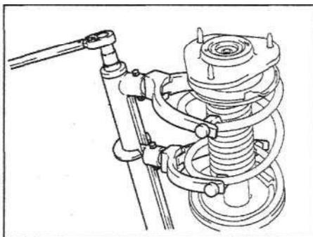
б) С помощью специнструмента сожмите пружину.
