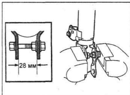
2. Снимите пружину,
