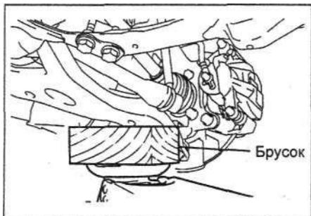
в) Отверните два болта, две гайки крепления стойки к поворотному кулаку.
