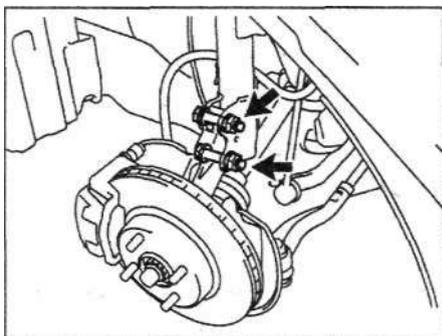
г) Отверните три гайки и снимите стойку в сборе.
