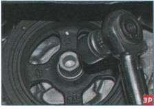
Головкой «на 22» с воротком отворачиваем болт крепления шкива.
