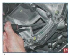
Фиксируем коленчатый вал от проворачивания, вставив лезвие отвертки между зубьями венца маховика и опираясь стержнем отвертки о ребро поддона.
