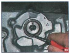
Поддев отверткой, вынимаем сальник из гнезда крышки привода ГРМ.
