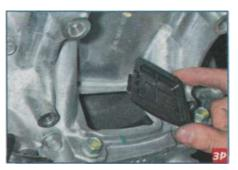
...и снимаем пластмассовую заглушку поддона картера.
