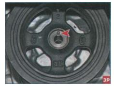
...совпадение его паза со штифтом носка коленчатого вала.
