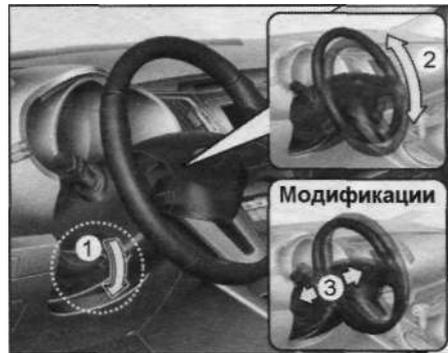
2. Верните рычаг блокировки в исходное положение, чтобы рулевое колесо надежно зафиксировалось. После регулировки убедитесь, что рулевое колесо не качается вверх-вниз.
