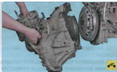
25. Сдвиньте коробку передач максимально назад, уберите из-под нее опору и снимите коробку передач с автомобиля.
