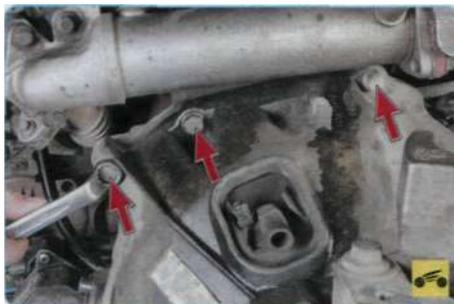
20. Выверните три верхних болта крепления коробки передач к блоку цилиндров двигателя...
