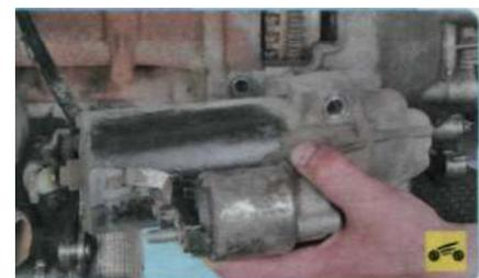
16. Снимите стартер (см. «Снятие и установка стартера», с. 179).
