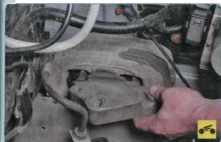
19. Снимите левую опору подвески силового агрегата (см. «Замена левой опоры подвески силового агрегата», с. 54).
