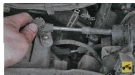
3. ...и отсоедините наконечник троса от пальца рычага переключения передач.
