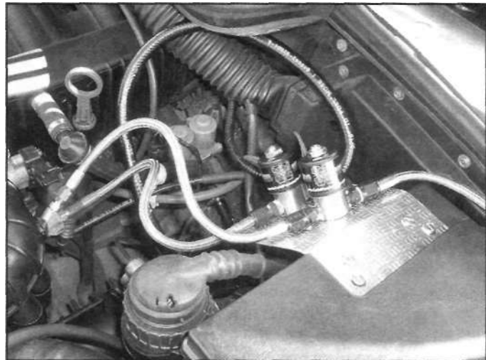
Система Cold Fusion - так называемая "влажная" система впрыска закиси азота с армированными шлангами подачи.
