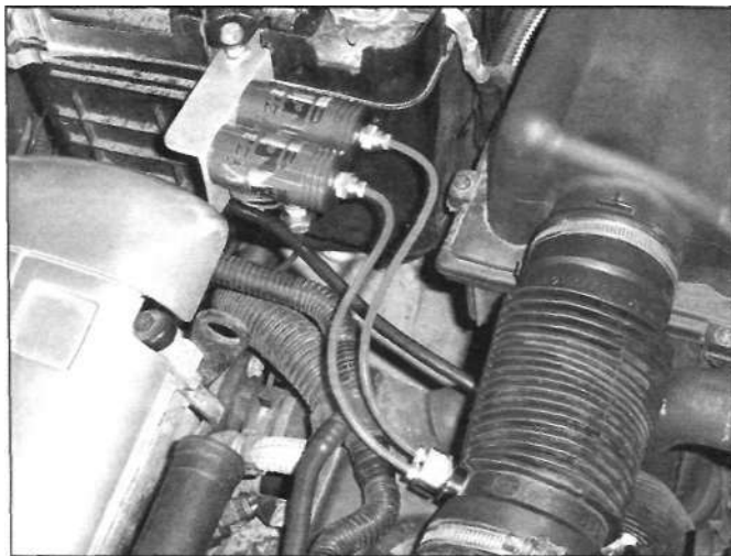
Типичная и простая система одиночного впрыска закиси азота (одна форсунка снабжает все цилиндры).
