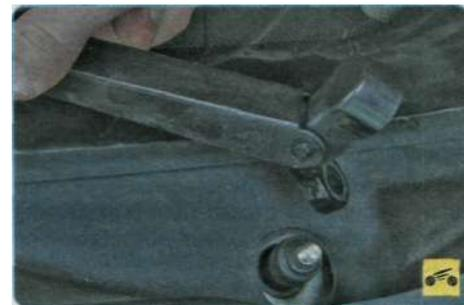
1. Снимите рычаги с валов поводков трапеции стеклоочистителя (см. «Снятие и установка рычагов стеклоочистителя ветрового окна», с. 256).
