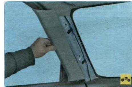
3. Снимите верхние облицовки передних стоек (см. «Снятие и установка облицовок салона», с. 252).
