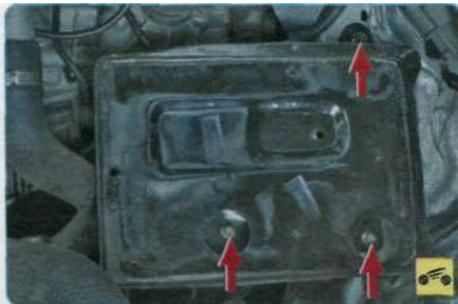
12. Выверните три болта крепления полки аккумуляторной батареи...
