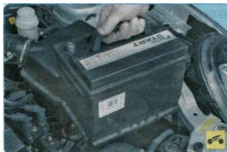
10. Извлеките аккумуляторную батарею из моторного отсека.
