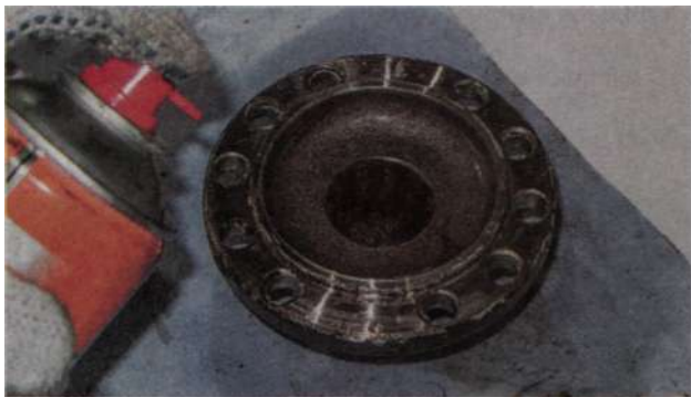
41. Наносим маслостойкий герметик.
