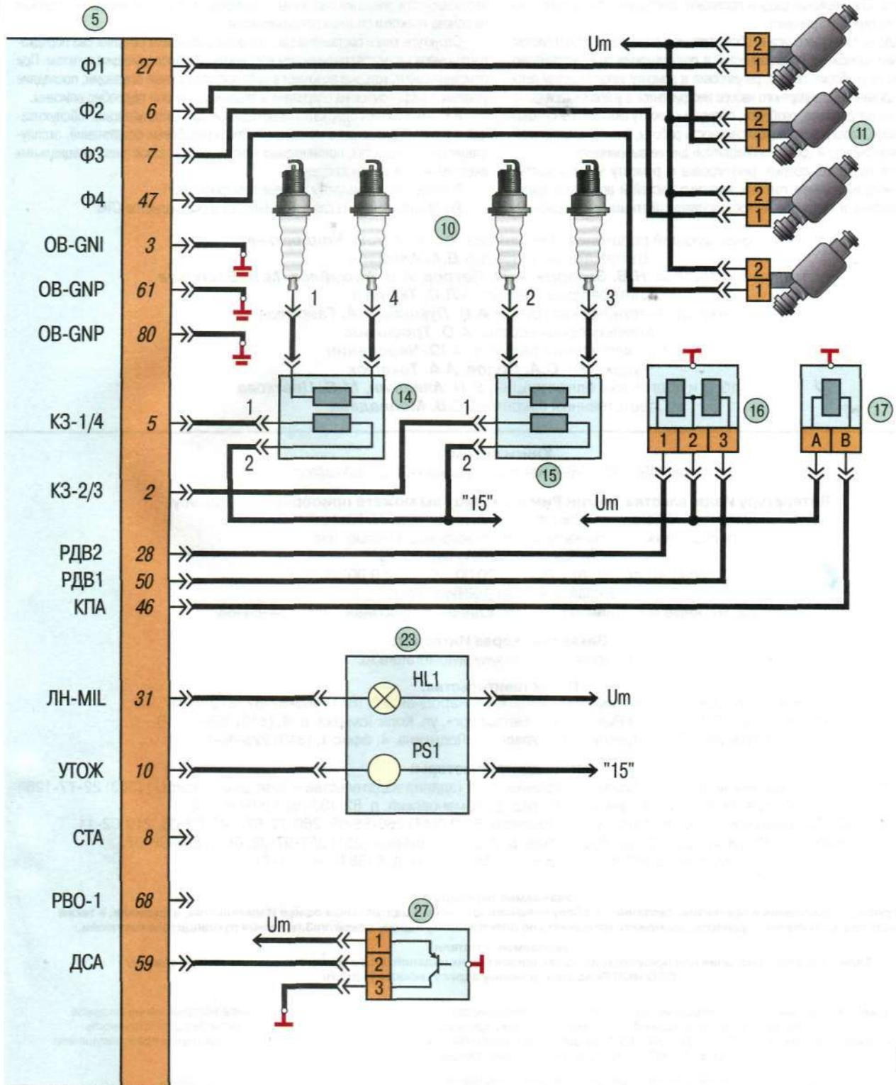
адсорбера; 18 – датчик неровной дороги; 19 – датчик массового расхода воздуха; 20 – датчик положения дроссельной заслонки; 21 – датчик положения распределительного вала; 22 – датчик детонации; 23 – комбинация приборов; 24 – датчик температуры охлаждающей жидкости; 25, 26 – датчики концентрации кислорода; 27 – датчик скорости автомобиля
