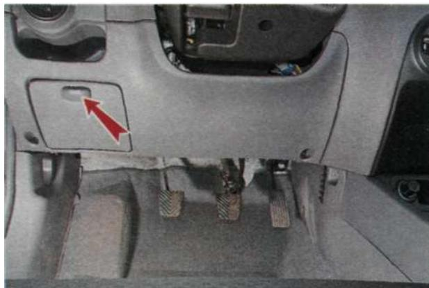
...и торцовым ключом на 10 мм выворачиваем два болта крепления колодки к облицовке.
