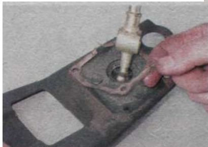
10. Снимаем уплотнительную прокладку.
