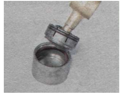
16. Снимаем с рычага ползун.
