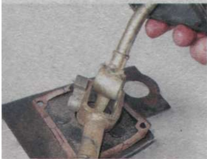
10. Снимаем уплотнительную прокладку.
