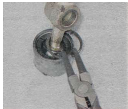
15. Специальным съёмником снимаем стопорное кольцо.
