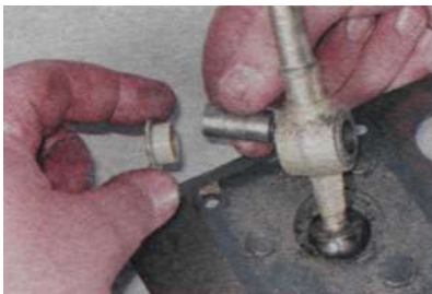
15. Специальным съёмником снимаем стопорное кольцо.
