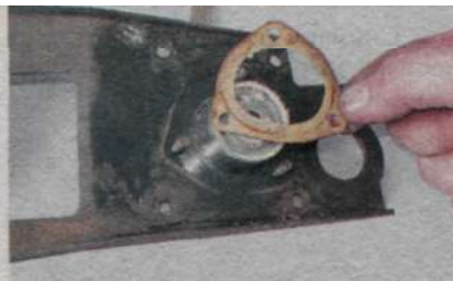
14. Извлекаем рычаг из отверстия опорной пластины.
