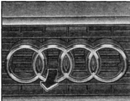
3.1 Рычаг дополнительного фиксатора капота
