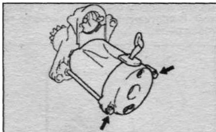
3. Вытяните заднюю крышку стартера в сборе с якорем из корпуса стартера.
