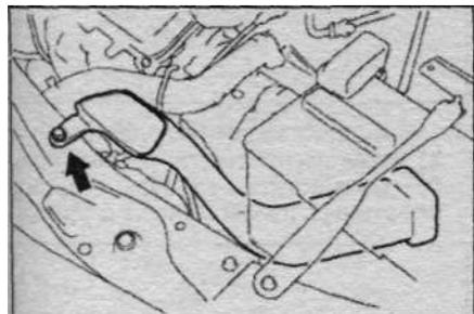
10. Установите воздушный фильтр (см. главу "Двигатель 2GR-FE (3,5 л) - механическая часть").
