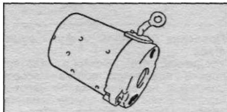
4. Снимите крышку редуктора.
