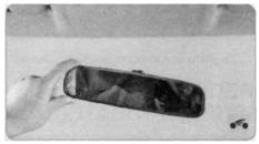
Положение внутреннего зеркала заднего вида регулируют поворотом его в нужную сторону на шарнире кронштейна.
