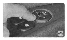
Для регулировки положения зеркала нажилте на соответствующую сторону круглой клавиши Б.
