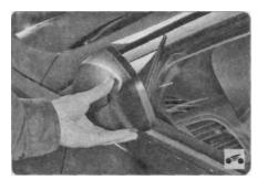
Дгя уменьшения габарита автомобиля при парковке в местах с интенсивным движением наружное зеркало можно сложить, повернув на шарнире рукой.
