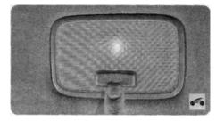
DOOR - освещение салона включается при открывании дверей;
