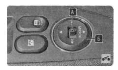
На автомобилях с электроприводом зеркала регулируют с блока управления, расположенного на подлокотнике двери водителя водном блоке с клавишами управления электростеклоподъемниками. Для регулировки положения зеркал необходимо, чтобы ключ в выключателе зажигания находился в положении «ON» (включено).
