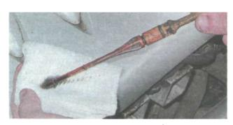
4. Вставляем указатель уровня обратно в отверстие блока цилиндров до упора. Затем повторно извлекаем указатель уровня. Уровень масла должен находиться между метками А и Б.
