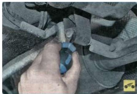
4. Поддев отверткой, сдвиньте переднюю подушку подвески системы выпуска отработавших газов...
