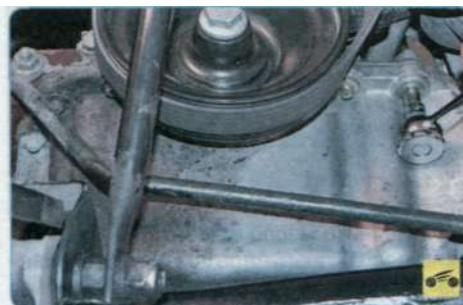
9. ...пять болтов крепления к блоку цилиндров спереди...
