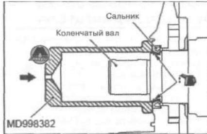
2). Установить сальник в передний корпус при помощи специального инструмента (MD998382).
