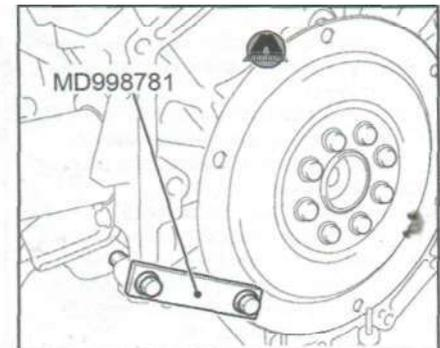
3) Зафиксировать ведущий диск при помощи специального приспособления (MD998781).
