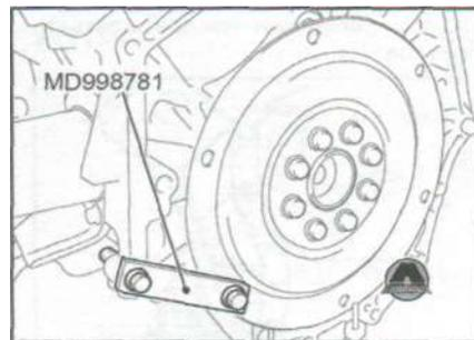
1) Зафиксировать ведущий диск при помощи специального приспособления (MD998781).
