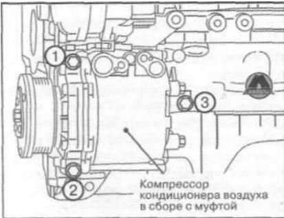
Вкрутить и затянуть монтажные болты компрессора кондиционера воздуха рекомендуемым моментом затяжки в порядке, указанном на рисунке.
