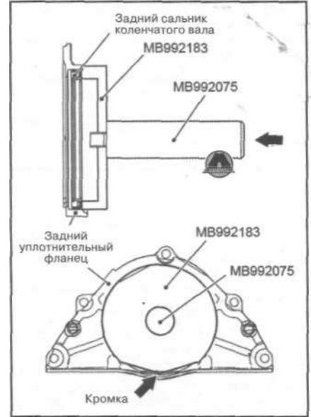
1) Нанести тонкий слой чистого моторного масла по внутреннему периметру кромки заднего сальника коленчатого вала.
