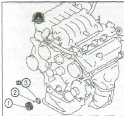
1. Снять звездочку коленчатого вала (1).
